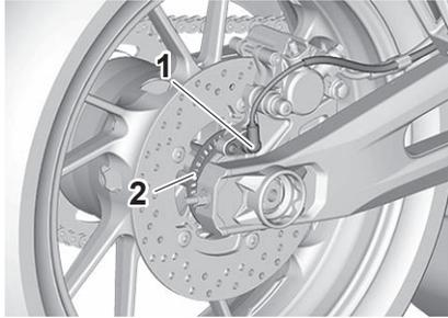
1. Capteur de roue arrière
