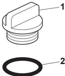
1. Bouchon de remplissage de l'huile moteur
