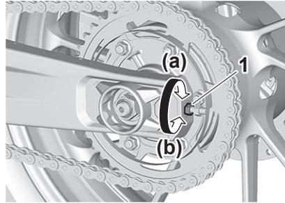
1. Écrou de réglage de la tension de la chaîne de transmission
