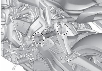
Faire contrôler les pivots du bras oscillant par un bras oscillant aux fréquences spécifiées dans le tableau des entretiens et graissages périodiques.
