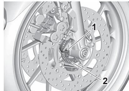
1. Capteur de roue avant
