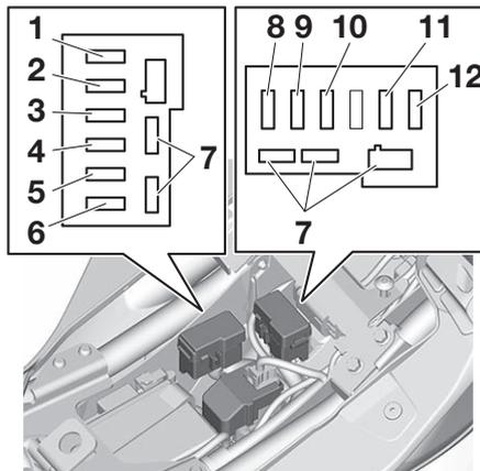
1. Fusible du moteur du ventilateur de radiateur
