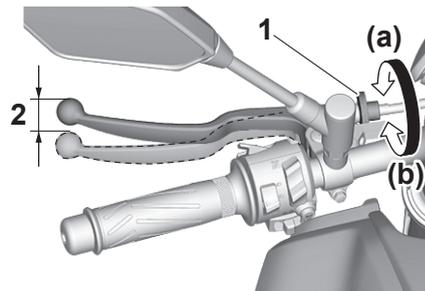
1. Vis de réglage de la garde du levier d'embrayage
